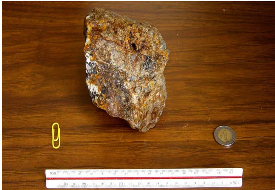
Fotografía 5.7 Muestra de roca húmeda de la brecha hidrotermal con fragmentos angulosos de origen calcáreo fuertemente silicificados, con presencia de calcita, barita, fluorita, hematita y limonita
