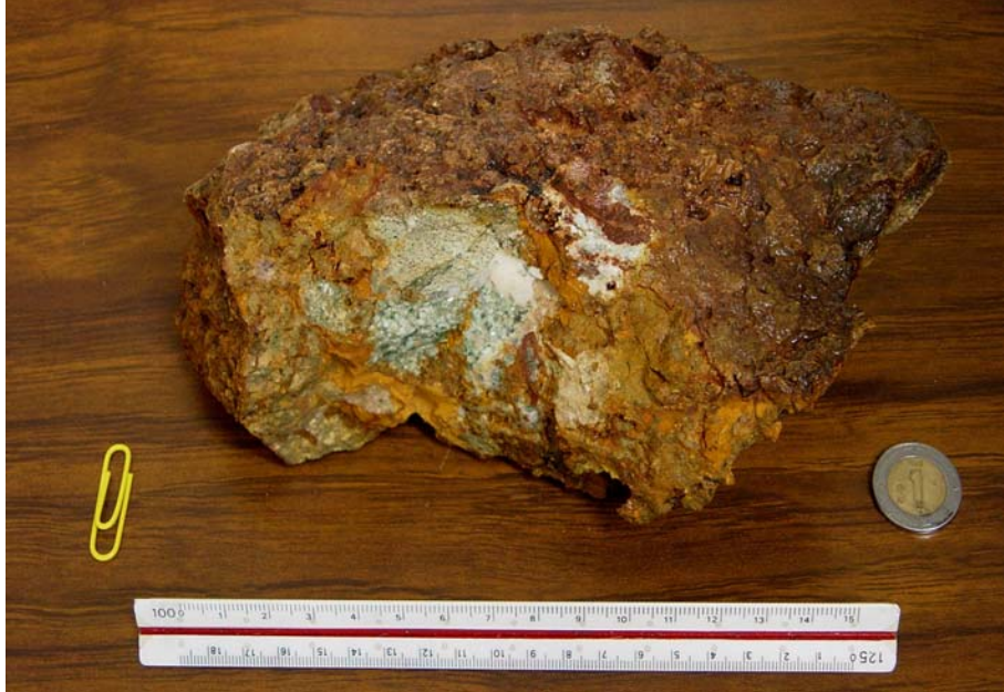
Fotografía 5.10 Muestra de roca húmeda de la brecha fuertemente silicificada, con fragmentos angulosos de riolita en una matriz enteramente silicificada, limonitizada y cloritizada
