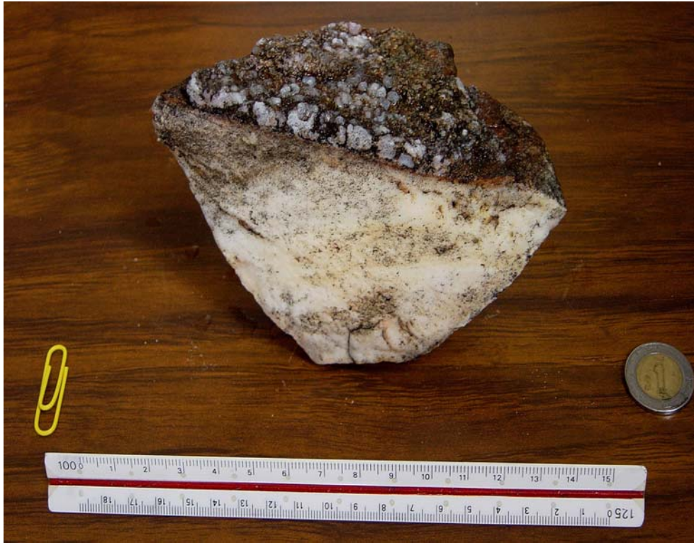
Fotografía 5.13 Muestra de roca húmeda en la que se muestra el desarrollo de calcedonia que tuvo lugar en las fracturas dentro del cuerpo subvolcánico, cerca de la zona de brecha. Obsérvese la fuerte silicificación de la roca encajonante
