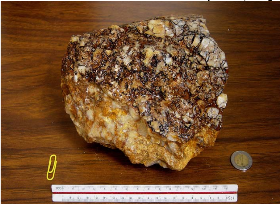
Fotografía 5.11 Muestra de roca húmeda de la zona de brecha con fragmentos angulosos fuertemente silicificados con presencia de calcita y barita
