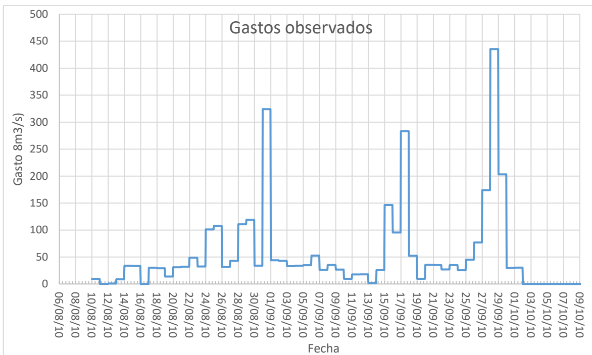
Figura 8.3 Gastos observados en la presa de la Laguna de Catemaco
