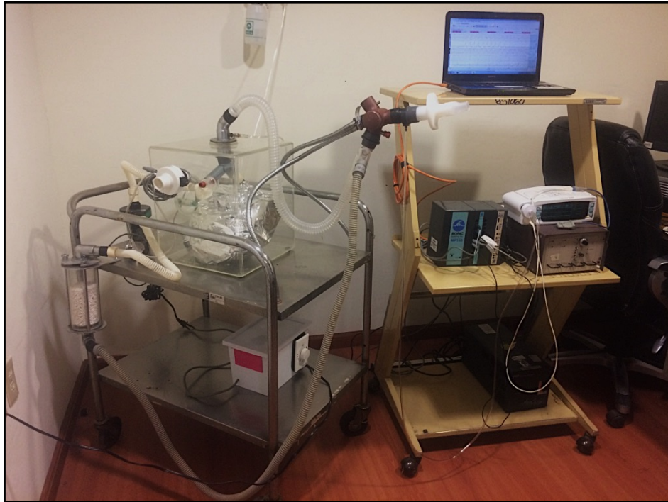
Figura 6: Sistema. Del lado izquierdo el circuito cerrado para re-respiración, del lado derecho los recursos para colección y procesamiento de señales.
