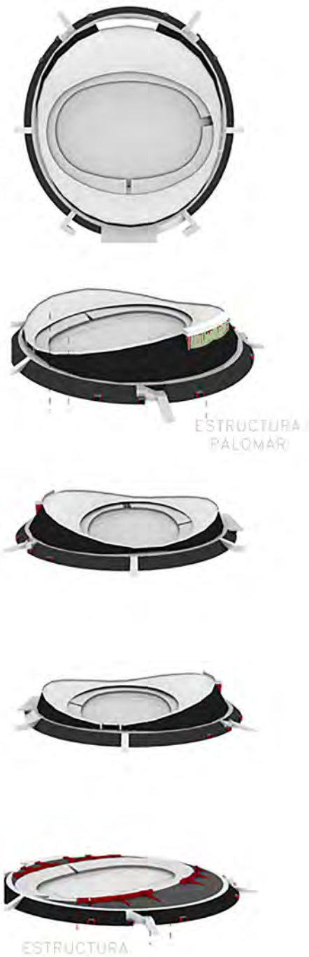
Imagen 61 Esquema mostrando estructura, zampeado de tierra, terraplén, estructura principal [ túnel ], nivel de tierra. .Imagen obtenida de revista UNAM
