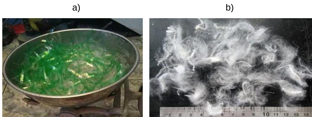
Ilustración 45. a) Fibra de PET del estudio 1, b) Fibra de PET del estudio 2. Imágenes tomadas de cada estudio correspondiente para fines académicos.
