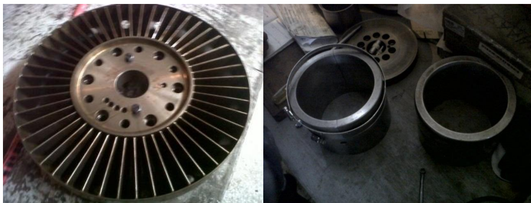
Figura 4.9. Turbineta y chumaceras.
