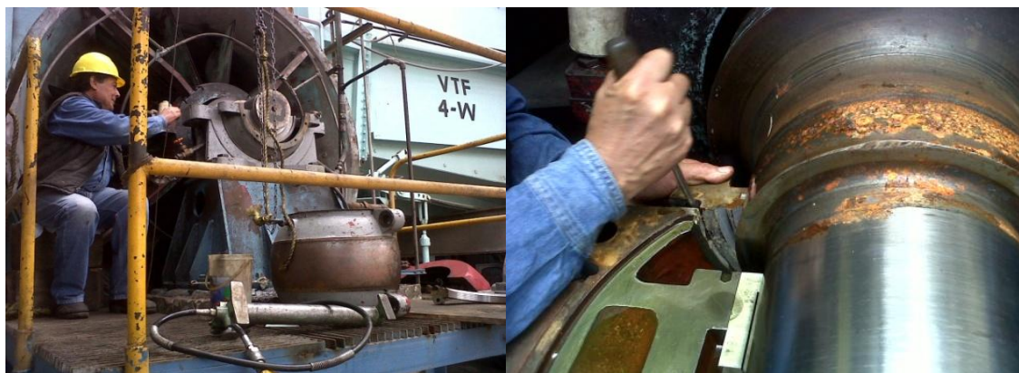
Figura 4. Desensamble de las chumaceras VTF.
