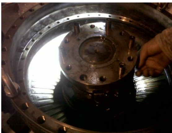
Figura 4.7. Retiro de los tornillos del eje captador.
