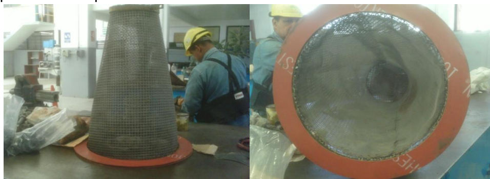
Figura 4.23. Limpieza de filtros.
