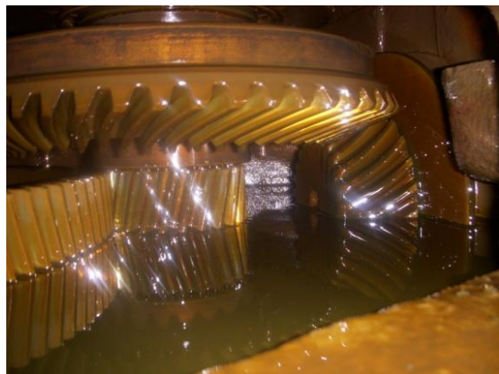
Figura 4.28. Interior del reductor con aceite.
